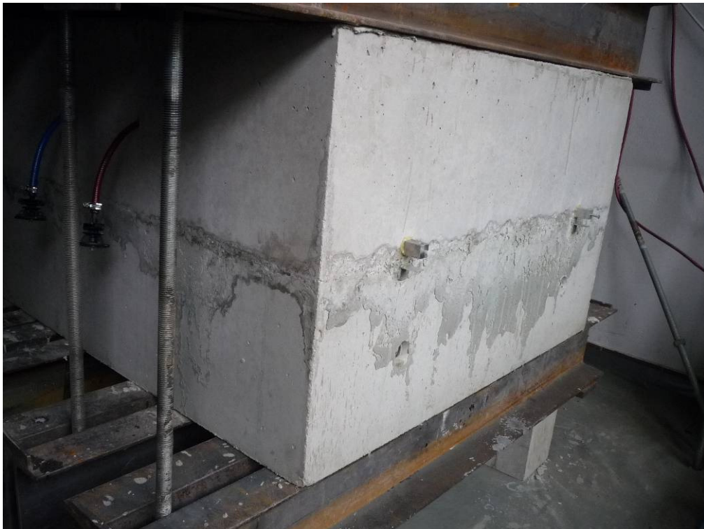
Bild 4: Prüfbehälter bei einem Wasserdruck von 0,4 bar nach ca. 22 Tagen – keine Feuchtestellen
