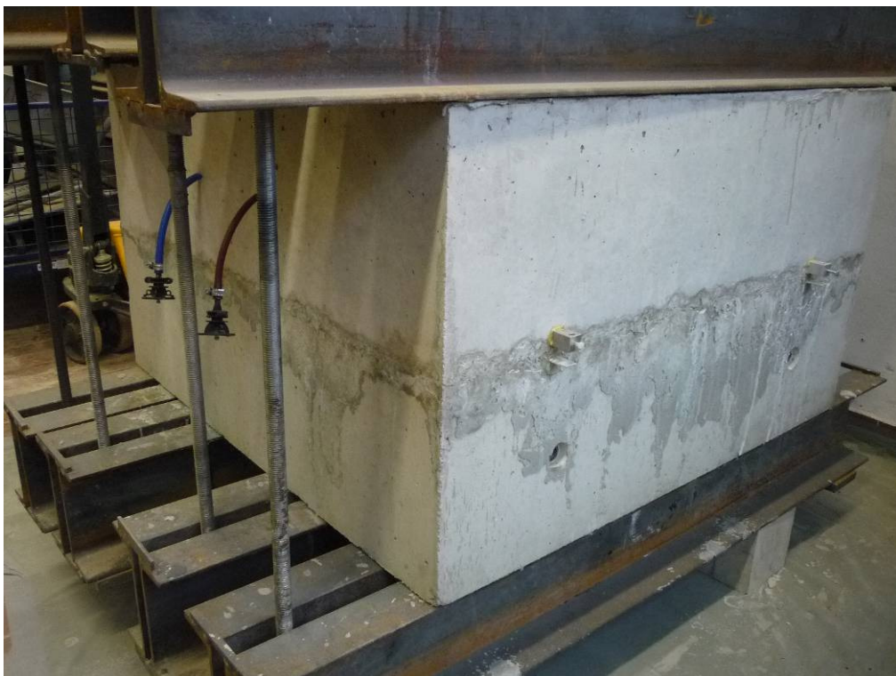
Bild 4: Prüfbehälter bei einem Wasserdruck von 2,0 bar nach ca. 31 Tagen – keine Feuchtestellen
